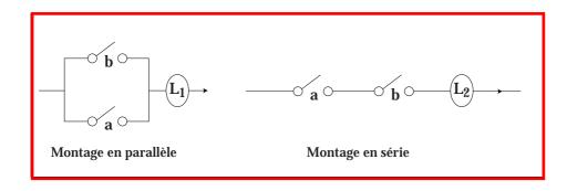
Notons a=1 l'état où l'interrupteur a est fermé (et le courant circule) et a=0 l'état contraire. Même chose pour b.
